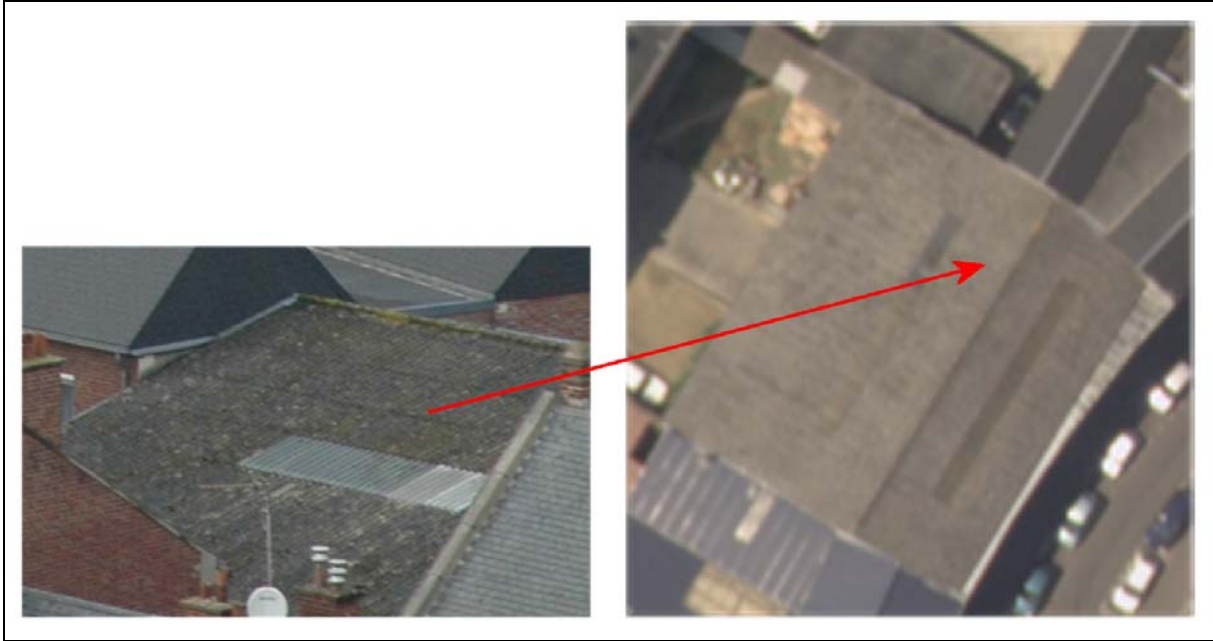
Figure 6-15 Exemple d'un toit en fibrociment.
