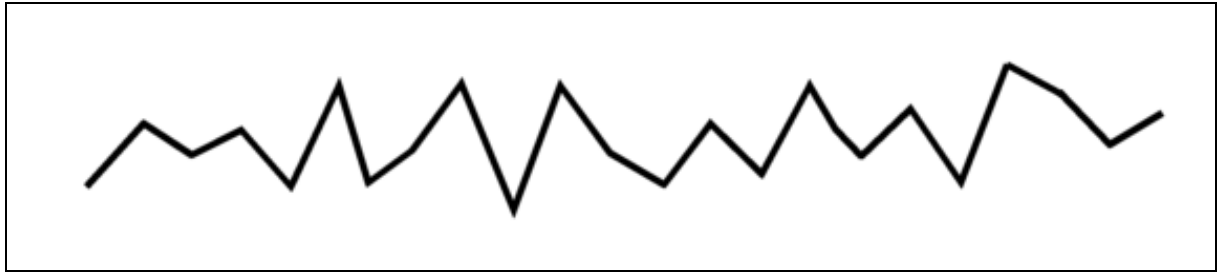
Figure 4-4 microfacettes en forme de « V » modélisant la microsurface des matériaux, vues en coupe.
