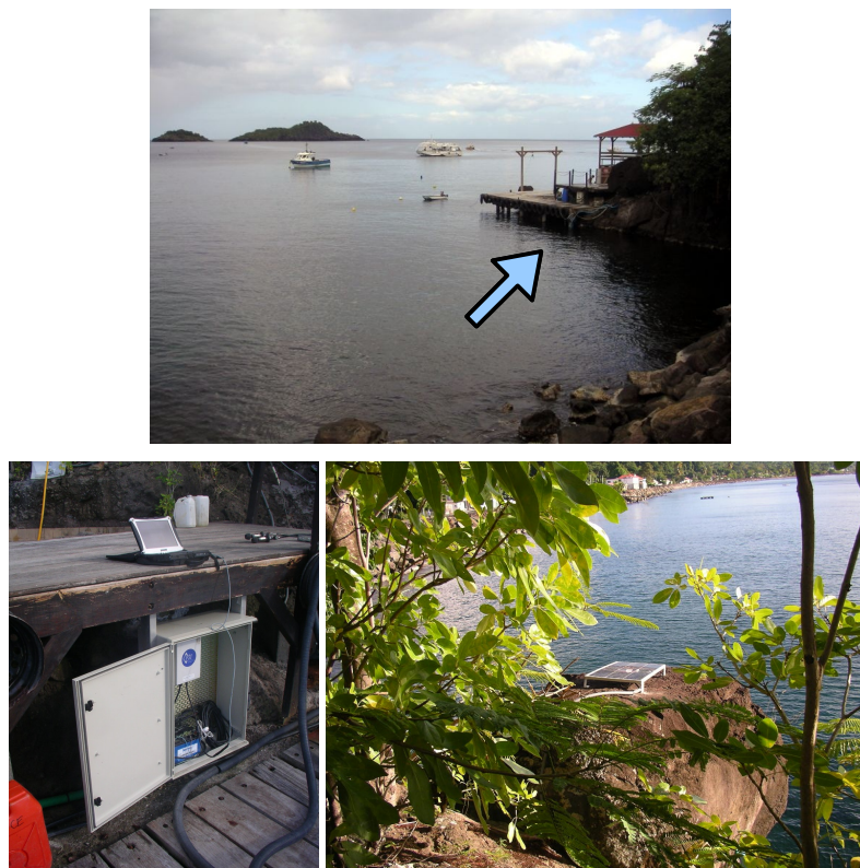
Figure 9. Site de Malendure : vue du ponton, récupération des données au moyen du PC portable, panneaux solaires installés sur un rocher distant et exposé plein sud.
