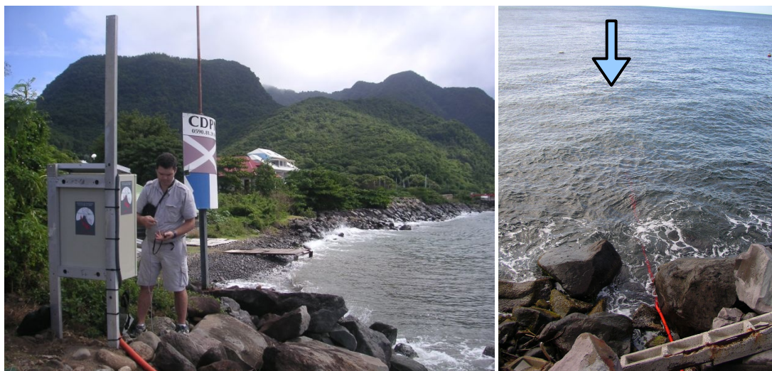
Figure 13. Site CNBT : récupération des données (Pascal RIVAL), capteur placé à 20 m vers le large et relié à un câble gainé. En arrière plan, le Houëlmont avec une possibilité de transmission radio des données (mât prévu à cet effet)
